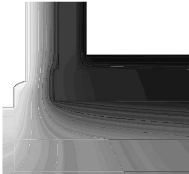
Abbildung 7: Die optimale, wärmebrückenfreie Dämmung unter der Bodenplatte mit wärmebrückenfreiem Anschluss der Außenwand (auch Kellerwand) und vollständig in der warmen Hülle liegenden Innen- und Trennwänden. Der \Psi -Wert des gezeigten Anschlusses liegt bei etwa -0,03 \text{ W/(mK)} . Der verwendete Dämmstoff kann auch in zwei Lagen eingesetzt werden und selbst die Aufnahme von Horizontallasten ist in einem gewissen Ausmaß zulässig. [Sariri 2005]
